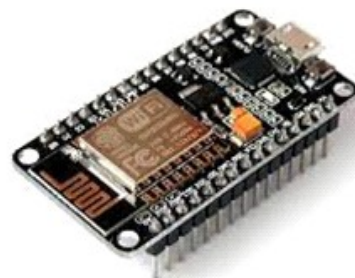
Fig.3 : ESP8266 Wi-Fi module (NodeMCU)
